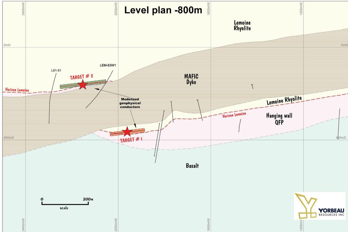
Figure 3 : Plan niveau, -800 mètres, montrant un dyke mafique qui recoupe et déplace l'horizon Lemoine. La cible #1 est localisée sur le côté sud du dyke tandis que la cible #2 est localisée sur le côté nord.
