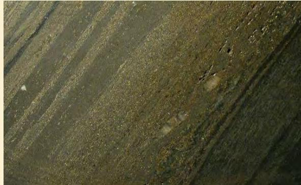
Forage 03-BES-04, 321.3 m - Sulfures semi-massifs (pyrite, pyrrhotite avec sphalérite et chalcopyrrite)
